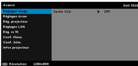
**SORTIE VGA**—Choisissez ON ou OFF pour activer ou désactiver la fonction de sortie VGA lorsque le projecteur est en mode veille. Le réglage par défaut est OFF.
