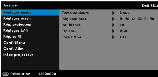
**TEMP COULEURS**—Pour régler la température des couleurs. L'écran apparaît plus froid à des hautes températures de couleur et plus chaud avec des températures de couleur plus basses. Lorsque l'utilisateur ajuste la valeur dans le menu **Ajuste couleurs**, le mode **PERSO** est activé. Les réglages sont enregistrés dans le mode **PERSO**.
